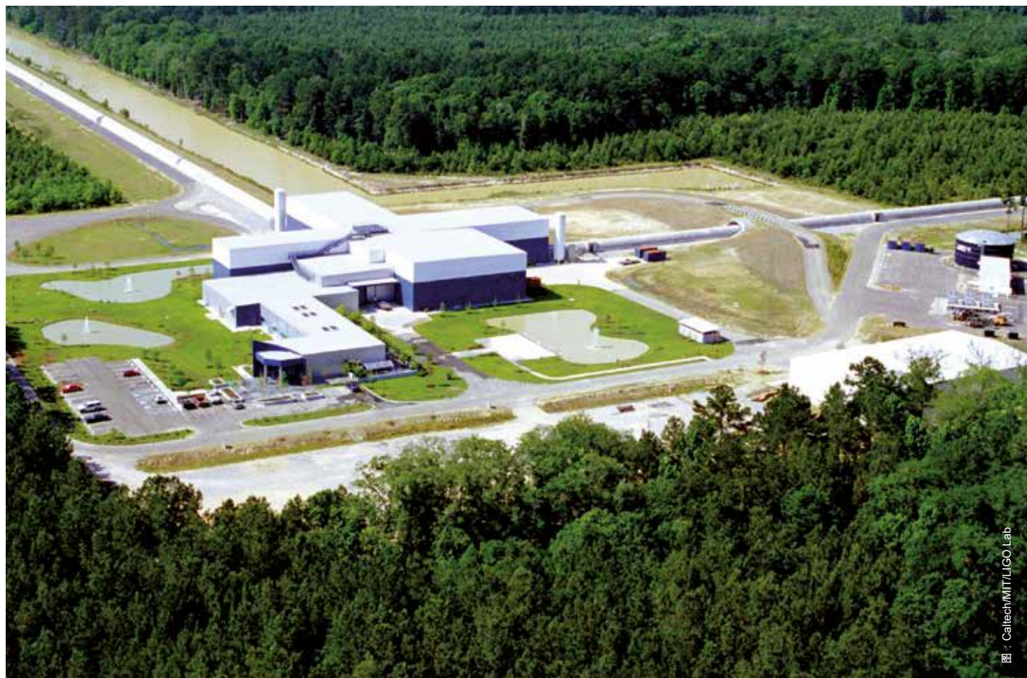
图 1：LIGO 探测器的两条 4 km 长真空管悬臂之一的俯视图（路易斯安娜）
