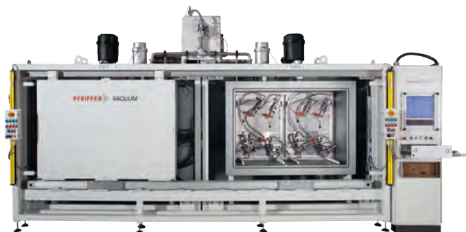
Abbildung 8-7: Helium-Lecksuchanlage LTS clima KLS/72 zur Dichtheitsprüfung von Kältemittelleitungen
