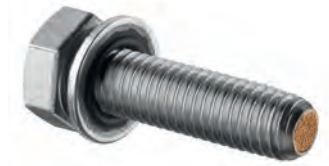
Abbildung 8-6: Beispiel eines Prüfleckes (Kapillarleck) integriert in eine Schraube zum Einbau in ein Master-Teil
