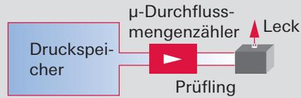
**Messung mit Micro-Flow-Sensor:**
