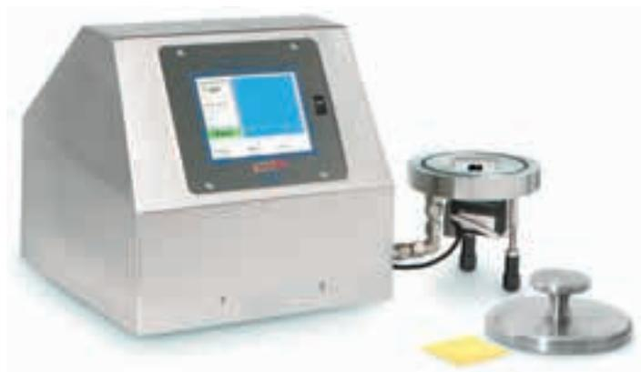
Testaufbau für die Dichtheitsprüfung von Beuteln
