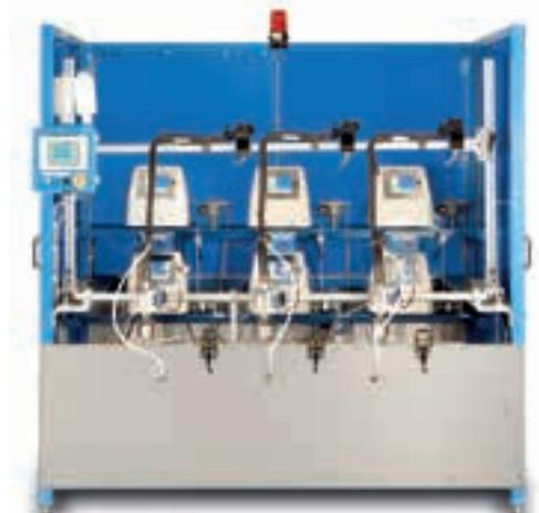
Micro-Flow-Prüfsystem für Treibstoffeinfüllstutzen
