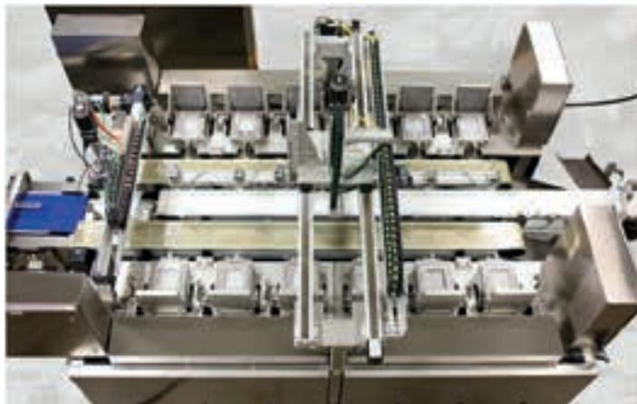
100% In-Line-IV-Beutel/-Behälterverschlussintegritätsprüfung (CCIT)
